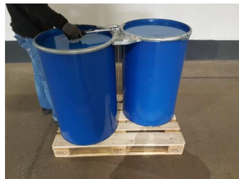
Schraube mit 35 Nm mittels Drehmomentschlüssel festziehen
