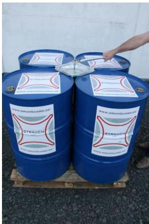
Schraube mittels Drehmomentschlüssel mit 35 NM festziehen.
